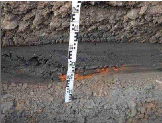
S3, 0,80-1,70 uGOK: Probe S3-3, muffig bis faulig reichender grauer Ton / Schluff mit Spuren von Ziegeln und Holz, mit organischen Beimengungen
